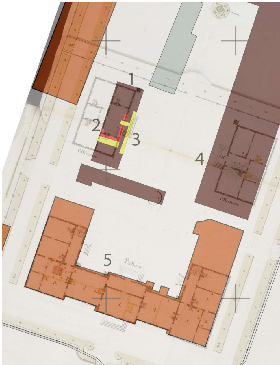
Ryc. 10. Plan Walthera z naniesionymi odkryciami z roku 2019. Kolorem żółtym oznaczono odkryte fundamenty wozowni, brązowy prostokąt to zarys wozowni przed rozbiórką, czerwonym kolorem oznaczono budynek o metryce średniowiecznej bądź wczesnonowożytnej. Opr. A. Ginter
